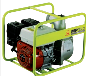
Motopompe thermique MP36-2 Moteur Honda GX120 essence 600l/min • code /200675
