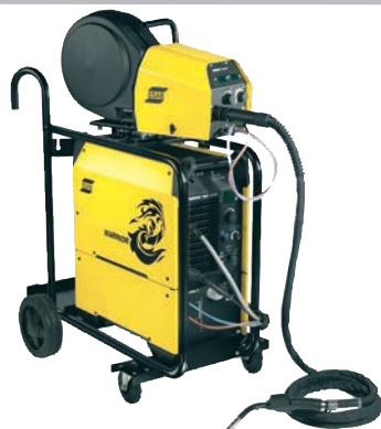
Poste à souder «Multiprocédé» (MIG/MAG, MMA, TIG) WARRIOR 400 I Complet Dévidoir 4 galets + faisceau + torche + chariot Fils pleins et fils fourrés de 0,8 à 1,6 mm ougeage à l'arc jusqu'à 10 mm électrodes basiques, rutilés et cellulosiques 380 V - 400 Ampères • code /47134
