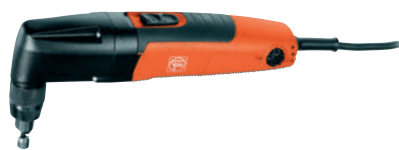
Grignoteuse FEIN BLK 1,3 TE Cap. acier 1,3 mm Vitesse de coupe 2,3 m/mn - Poids 1,8 kg • code /6078
