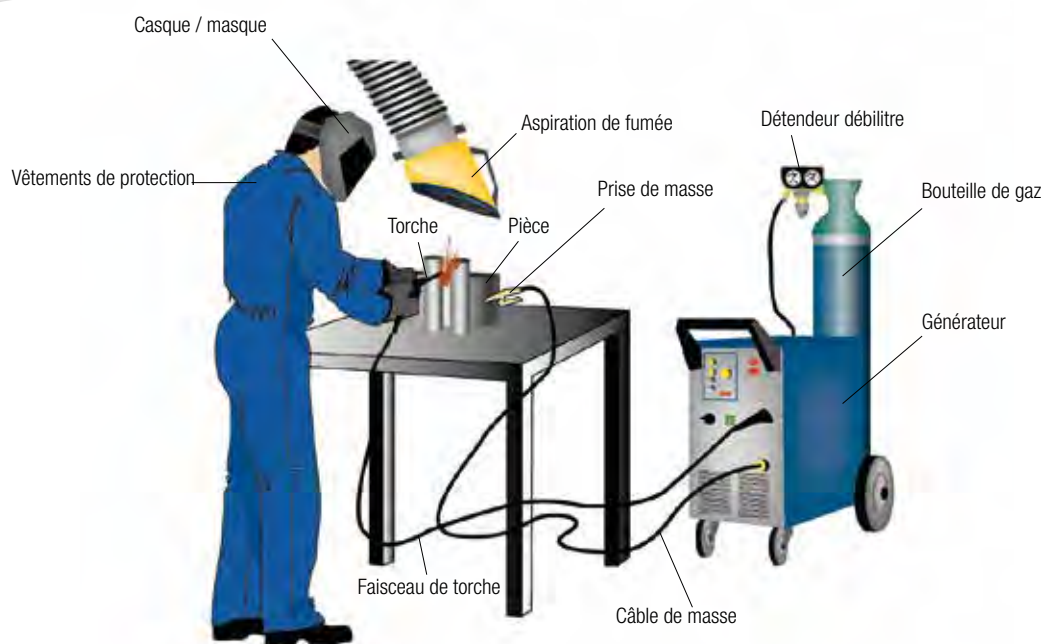
Composition type d'une installation manuelle de soudage MIG/MAG
